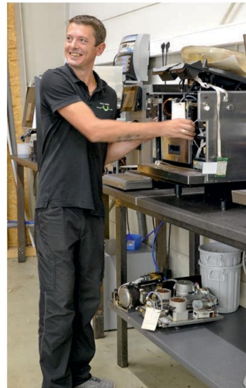
André Walter steht an der „Teststrecke“ – hier werden die zerlegten und aufgearbeiteten Module in und an den Kaffeemaschinen getestet.
